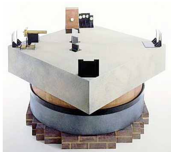
Figuur 1.9 Opstelling van het Michelson-Morley experiment
