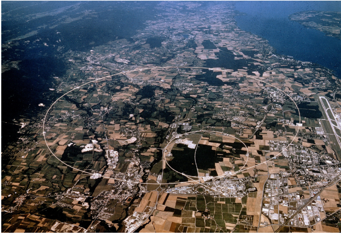
Figuur 15.4: Luchtfoto van het CERN laboratorium en omgeving. De grootste versnellertunnel is aangegeven met de grootste witte cirkel. In deze tunnel was de LEP (Large Electron Positron) versneller geplaatst en wordt op het moment de LHC (Large Hadron Collider) opgebouwd. De wat kleinere cirkel die in de grote cirkel ligt is de tunnel van de SPS, het Super Proton Synchrotron. Deze versneller is ook een tijd in gebruik geweest als een proton-anti-proton botser en heette toen het S\bar{p}\bar{p}S . Rakend aan de grote cirkels midden onder in het beeld is het hoofdterrein van CERN herkenbaar als een driehoekig stuk bebouwd land. Het hoofdterrein van CERN is midden onder herkenbaar als een driehoekig bebouwd stuk grond. Linksonder is het plaatsje St. Genis-Pouilly te herkennen, linksboven Gex en recht bovenaan Divonne Les Bains. Ook herkenbaar zijn rechtsboven een deel van het meer van Genève, helemaal rechts een deel van het vliegveld Cointrin en linksboven de hoogste bergketen van de Jura.
