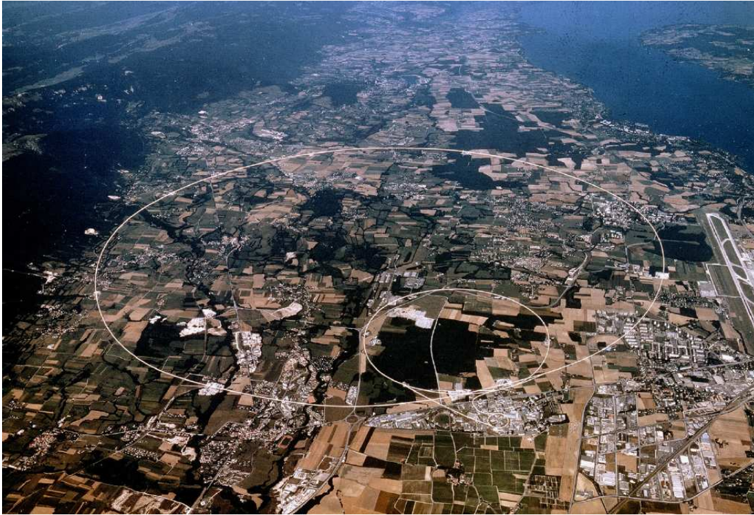
Figuur 10.1: Luchtfoto van het CERN laboratorium en omgeving. De grootste versnellertunnel is aangegeven met de grootste witte cirkel. In deze tunnel was de LEP (Large Electron Positron) versneller geplaatst en wordt op het moment de LHC (Large Hadron Collider) opgebouwd. De wat kleinere cirkel die in de grote cirkel ligt is de tunnel van de SPS, het Super Proton Synchrotron. Deze versneller is ook een tijd in gebruik geweest als een proton-anti-proton botser en heette toen het Spp\bar{S} . Rakend aan de grote cirkels midden onder in het beeld is het hoofdterrein van CERN herkenbaar als een driehoekig stuk bebouwd land. Op het CERN terrein zijn nog verschillende andere versnellers die nu hoofdzakelijk als voorversnellers worden gebruikt voor het SPS, LEP en de LHC. Het hoofdterrein van CERN is midden onder herkenbaar als een driehoekig bebouwd stuk grond. Linksonder is het plaatsje St. Genis-Pouilly te herkennen, linksboven Gex en recht bovenaan Divonne Les Bains. Ook herkenbaar zijn rechtsboven een deel van het meer van Genève, helemaal rechts een deel van het vliegveld Cointrin en linksboven de hoogste bergketen van de Jura.
